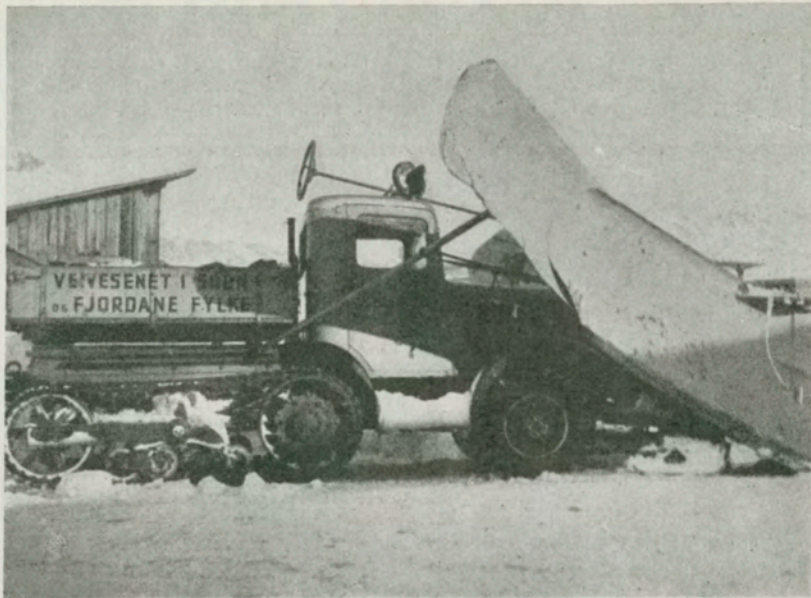
Fig. 2. Citroën beltebil med spesiell forplog av Øveråsens fabrikk.
